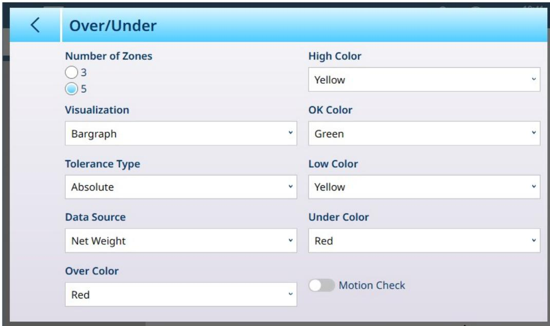
图 111: 目标称重 - 检重配置屏幕, 5 范围, 条形可视化
